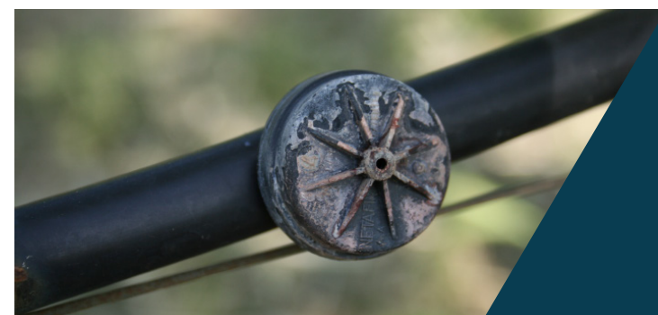
Degoter obstruït a causa d'un mal manteniment de la instal·lació (Foto: ECA Tàrraga).
