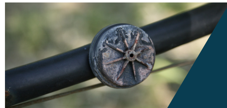
Gotero obstruido a causa de un mal mantenimiento de la instalación (Foto: ECA Tàrrrega).
