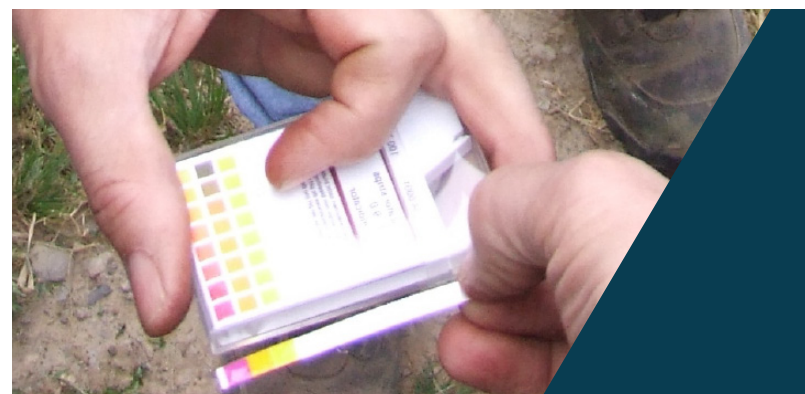
Tiras indicadoras para controlar el pH (Foto: ECA Tàrraga).
