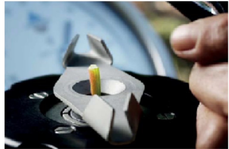
Potencial hídric de tije amb càmera de pressió com a indicador de l'estat hídric dels cultius. Foto: IRTA
